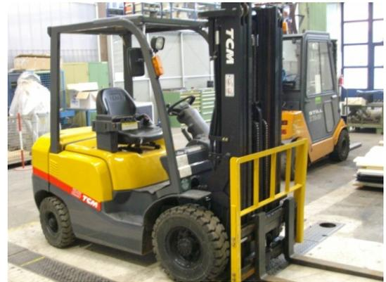
Der Gabelstapler kann eingesetzt werden, bis die Filterüberwachung den Fahrer anweist, die Maschine zu stoppen und die Regeneration über einen Druckschalter an der Instrumententafel der Filterüberwachung zu starten.
